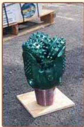
Drei Rollenmeissel vor dem Einsatz
